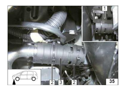
1 Жгут проводов отопителя 2 Жгут циркуляционного насоса
