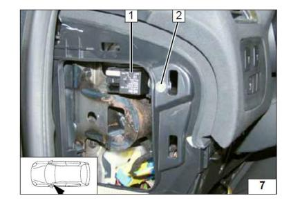
Соединить жгут проводов салонной колодки предохранителей 1 соединить в соответствии с цветами со жгутом из моторного отсека 2.
