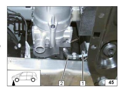
**1** Топливопровод и жгут проводов топливного насоса в гофрированной изоляции
