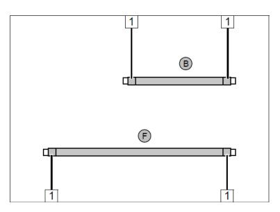
**1** Соединительный штуцер Ø18х18 мм, с поворотом на  $90^{\circ}$ , хомут Ø 25 мм **2** Хомут Ø 25 мм (2 шт)
