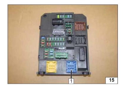
1 Синий трехштекерный 60-ти контактный разъем EBP 2 Центральный 20-ти контактный разъем
