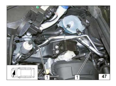
1 Штатное уплотнение 2 Топливопровод и жгут проводов топливного насоса в гофрированной изоляции
