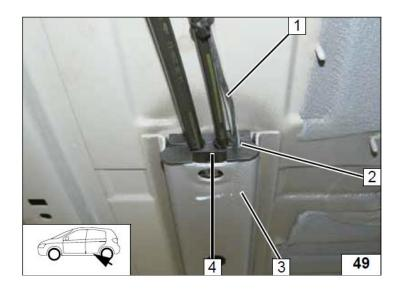
1 Жгут топливного насоса 2 Топливопровод
