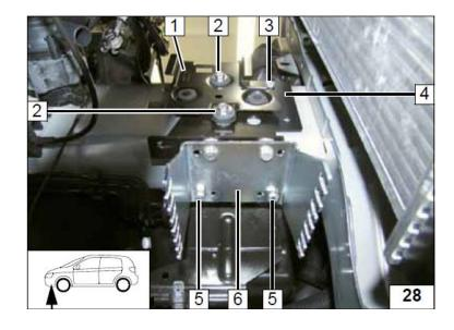
1 Подсоединительные жидкостные штуцера, уплотнительные кольца 2 Монтажный саморез 5х15, прижимная пластина
