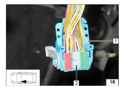
Удалить и заизолировать желтый (ge) провод **1** из гнезда 34 **2**. (Pin 34)
