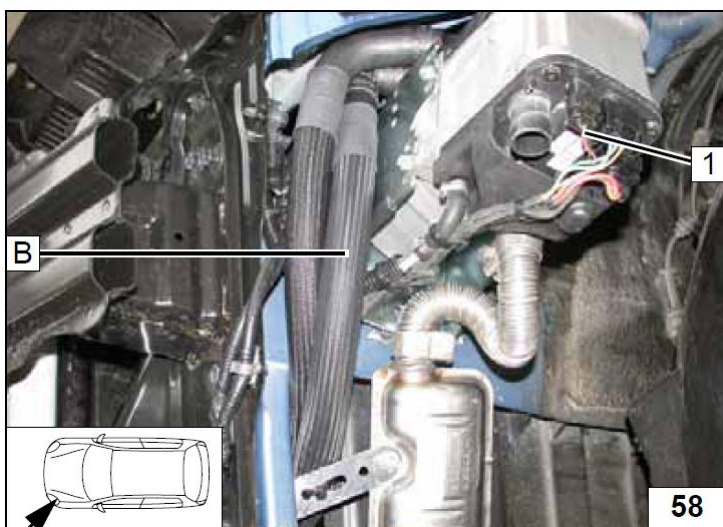
1 Жгут проводов циркуляционного насоса
